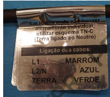
Foto 8 - Fiação externa da amostra.
